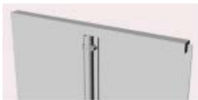
Überkleben Sie an der Poolinnenseite die Stoßstellen der Stahlwand mit einem Leinenband zum Schutz der Folie.
